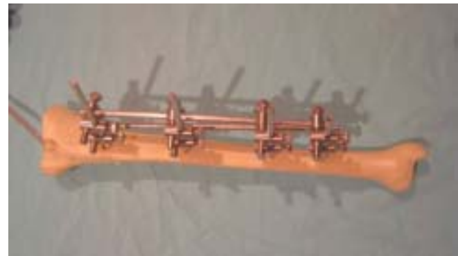
Figura 5. Modelo de fractura diafisaria, clavos aceptablemente alineados
