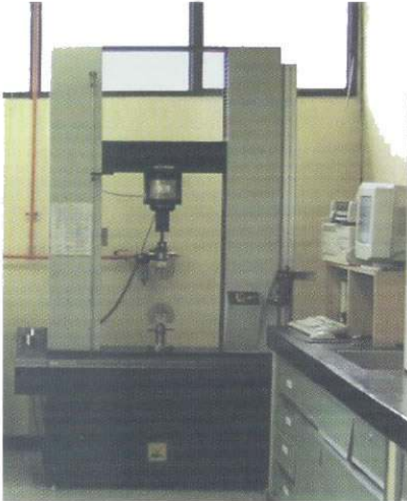
Figura 2. Máquina Instron 5.500 para pruebas en tensión entre 0 y 100 kN.
