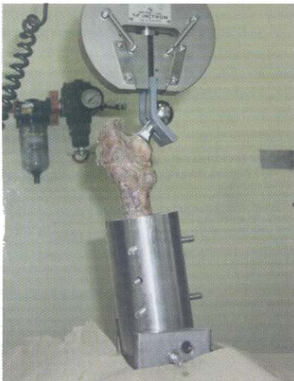
Figura 3. Sistema de fijación proximal y distal. El sistema distal está montado sobre un eje móvil que permite que la tracción se acerque al eje de la prótesis. El sistema proximal corrige parcialmente la discrepancia entre el eje de tracción y el eje de la prótesis.
