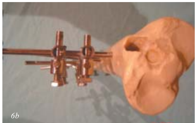
Figura 6 a y 6b. Modelo de fractura diafisaria, clavos desalineados
